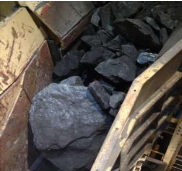
Figure 2: For å kunne transportere massen opp til siloen på en effektiv og sikker måte blir malmen knust ned i mindre biter ved hjelp av en kjefteknuser. Produksjonen går dag og natt, hele året rundt.
