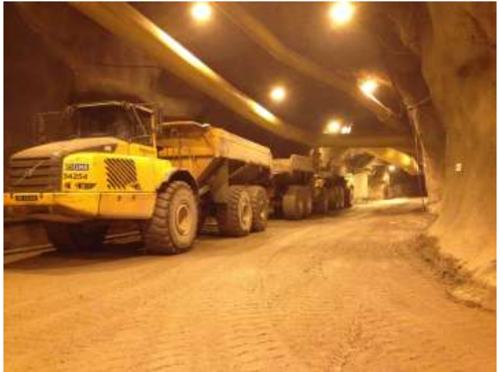
Figure 1: Dette bildet er fra det nederste nivået i gruva, ved siden av det underjordiske knuserommet. Dumperne henter massen fra ulike sjakter som går opp til produksjonsnivåene, som blir fylt opp etterhvert som lasterne i produksjonsfeltet fyller de ulike sjaktene.
